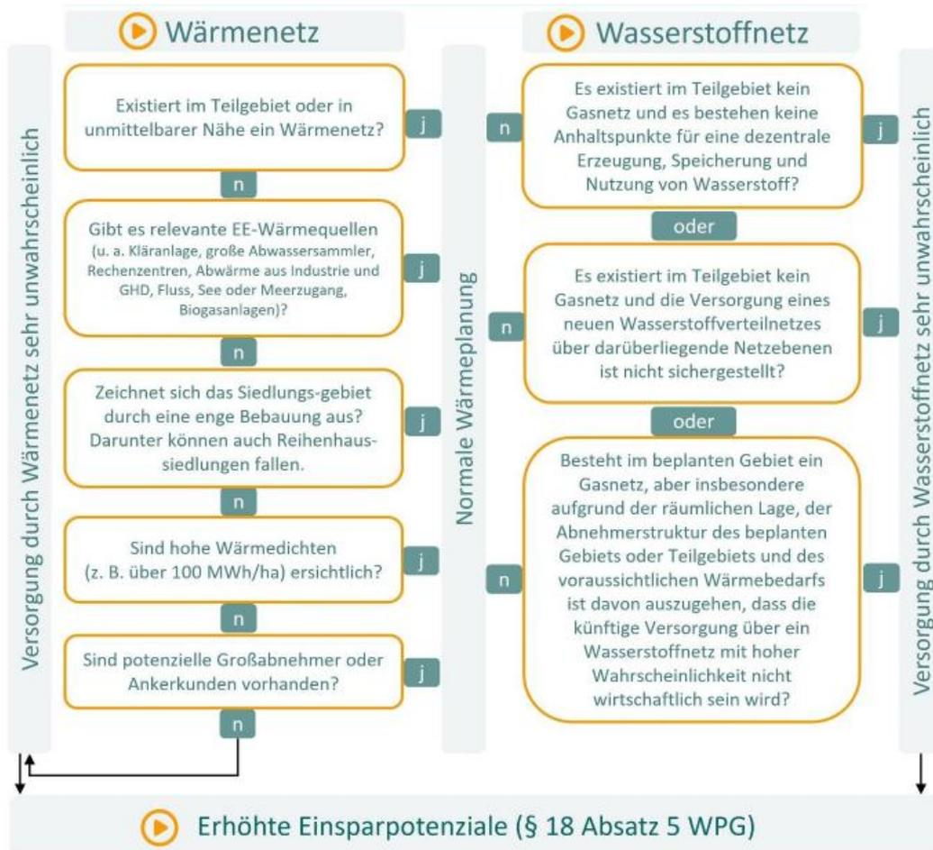
Abbildung 2-1: Prüfschema zur Entscheidungsfindung hinsichtlich der Durchführung einer verkürzten Wärmeplanung [10].
